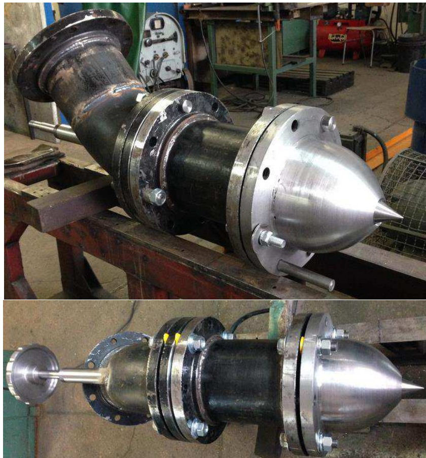
Figura 15 Proceso de soldado del Hilo hembra, primer armado del Inyector
