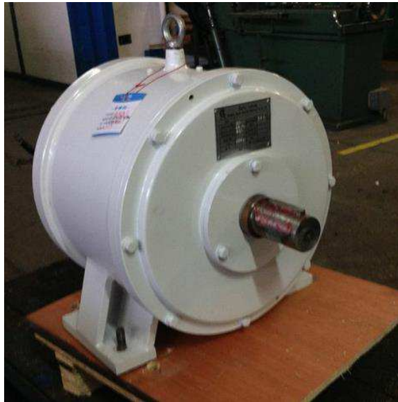
Figura B 19 Generador de imanes permanentes importado desde China
