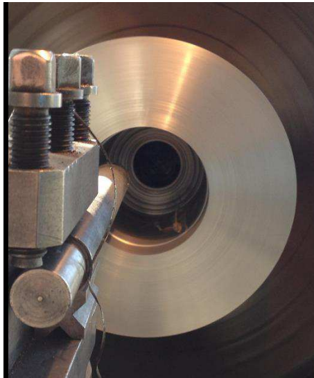
(a) Se perfora completamente y se comienza a expandir desde adentro hacia afuera
