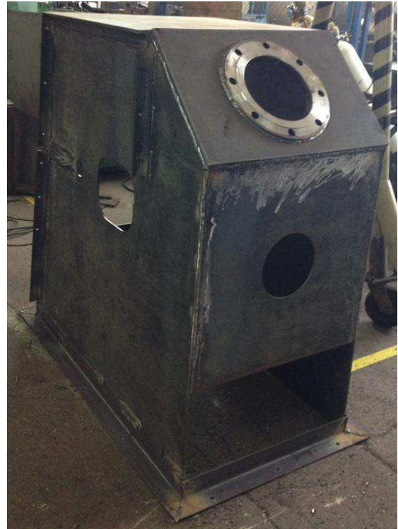
(b) Soldadura finalizada
