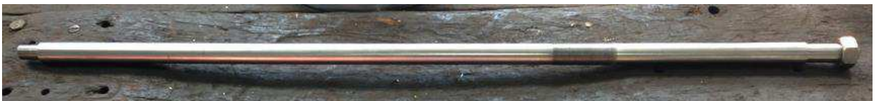
Figura 11 Eje del inyector terminado
