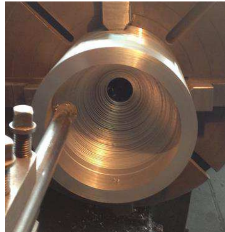
(b) Se entrega una plantilla con las medidas de la pared interior y se va ampliando según plano
