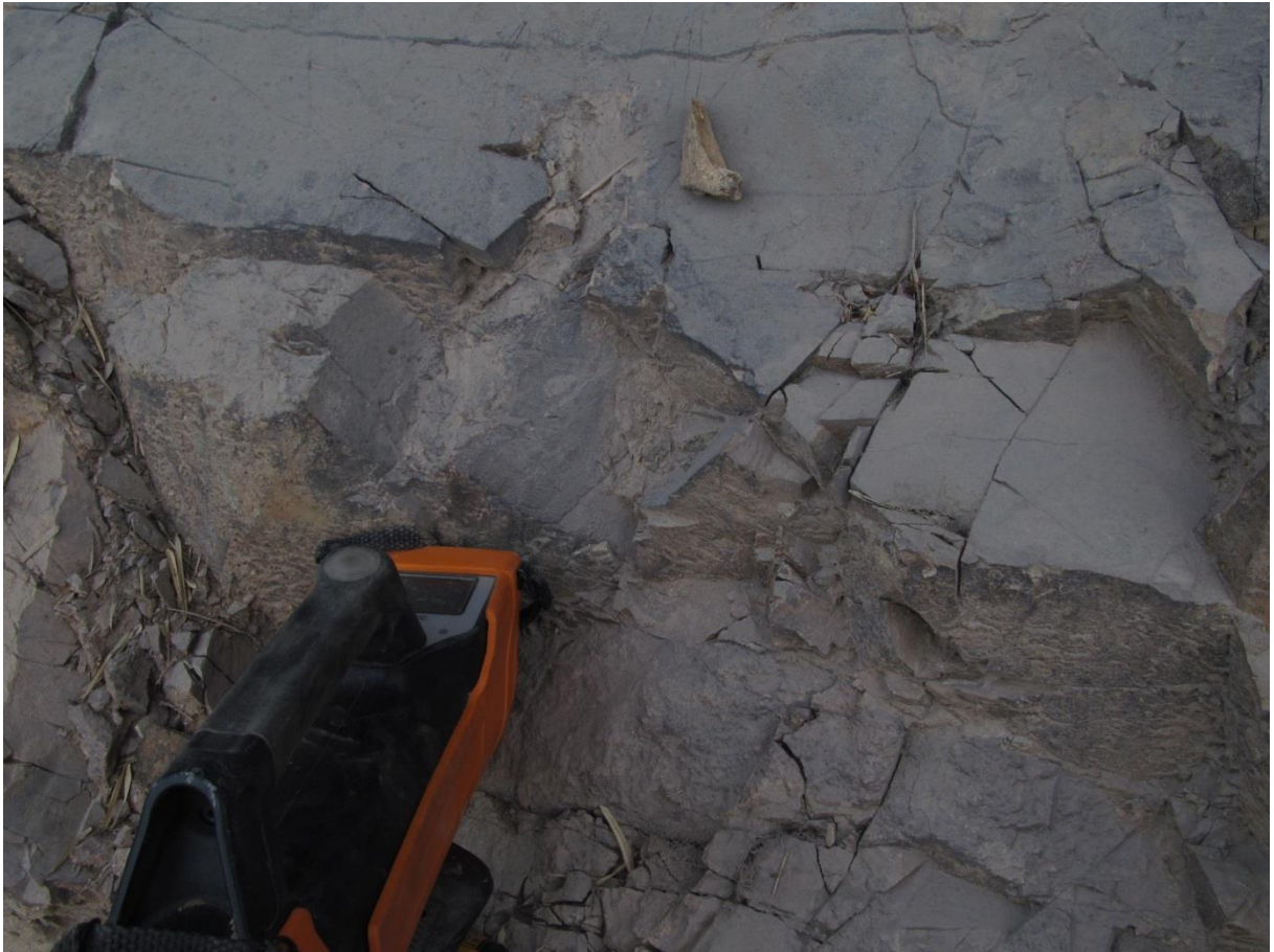
Figura 6: Medición con el espectrómetro de rayos gamma RS-125 de Radiation solution Inc.
