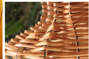
Detalle de tejido en Maqueta Exp. 4: problemas con ajuste de huiras en áreas rebajadas de la trama.
