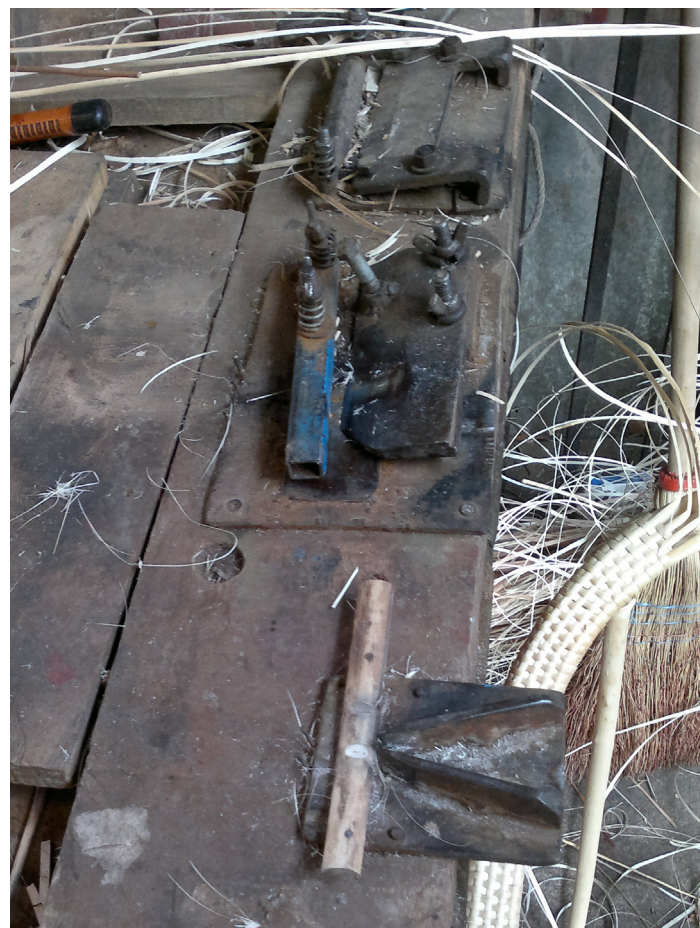
Fig.5 Herramienta manual de desmedulado y rebaje Elaboración propia
