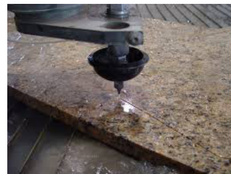
Fig. 21 Máquina corte al Agua trabajando en granito. En www.ametalcraft.com
