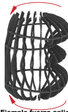
Fig. 81 Ejemplo fuerza aplicada arriba y abajo torciendo las costillas. Elaboración propia
