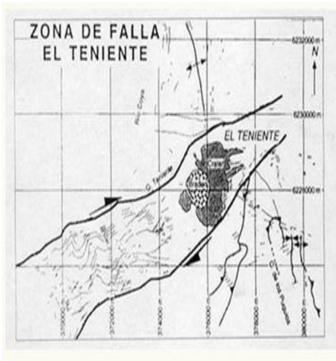
FIG. 2.8 Plano en planta con Fallas Principales
