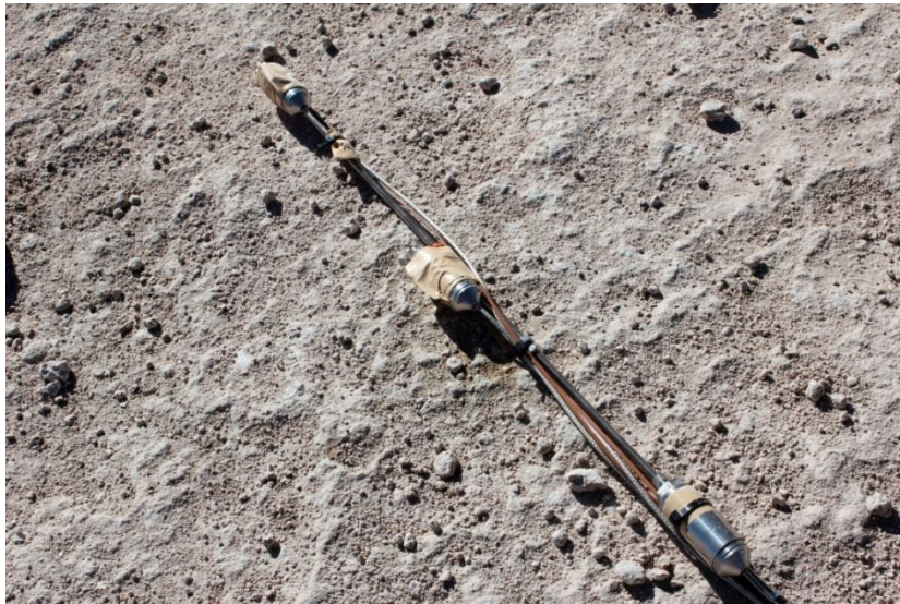
Figura 4.3 Instalación de las termocuplas y transductores de presión en las barras roscadas.
