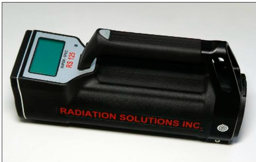
Figura 3.1: Espectrómetro/escintilómetro de rayos gamma portátil RS-125, de Radiations Solutions. Realiza conteo de rayos gamma mediante un detector de Sodio-Yodo que responde a energías de entre 30KeV-3.000KeV en 1.024 canales.
