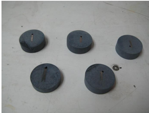
Fig [ 16 ]: Muestras montadas en baquelita
