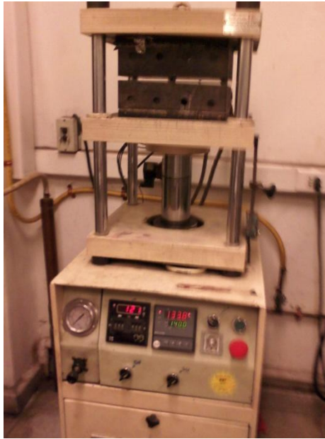
Figura 8: Prensa de laboratorio empleada en la elaboración de los paneles de plástico.
