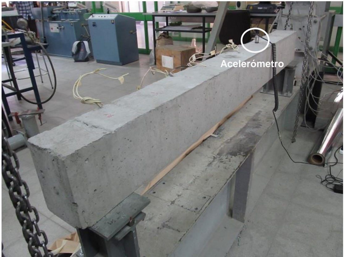
Figura 4-6: Viga montada en el marco de acero
