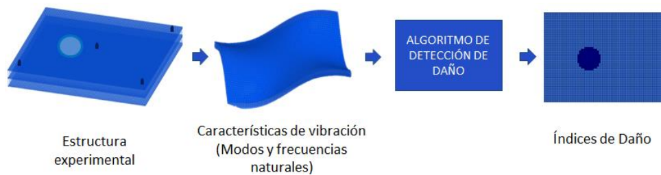
Figura 1.1: Estructura detección de daño mediante vibraciones
