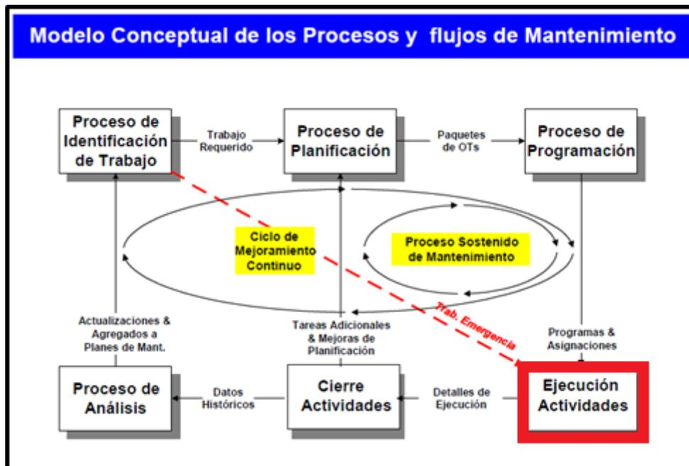
Figura 2: Diagrama de procesos del servicio, basado en la aplicación del ciclo de mantenimiento.
