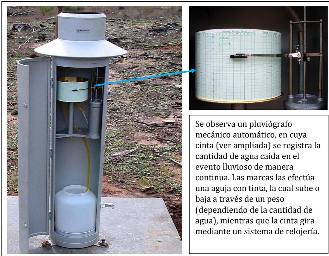
Se observa un pluviógrafo mecánico automático, en cuya cinta (ver ampliada) se registra la cantidad de agua caída en el evento lluvioso de manera continua. Las marcas las efectúa una aguja con tinta, la cual sube o baja a través de un peso (dependiendo de la cantidad de agua), mientras que la cinta gira mediante un sistema de relojería.
