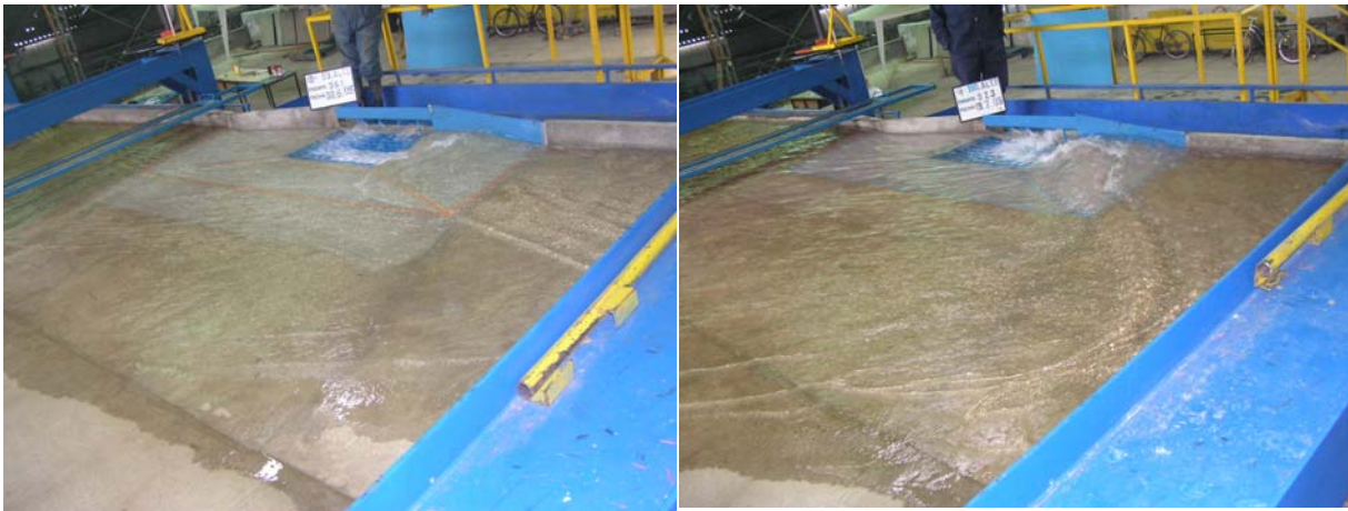
Figura 7.- Izq. Caso C: ( P_L=1\% ; P_T=2\% ; Q_T=80[\text{lt/s}] ) – Der. Caso D ( P_L=0.1\% ; P_T=3\% ; Q_T=180[\text{lt/s}] )
