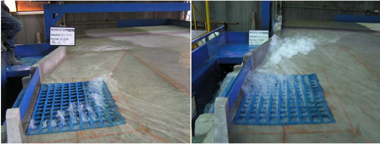
Figura 5.- Caso A: Izq. ( P_L=1\% ; P_T=2\% ; Q_T=40[\text{lt/s}] ) – Der. ( P_L=3\% ; P_T=3\% ; Q_T=180[\text{lt/s}] )
