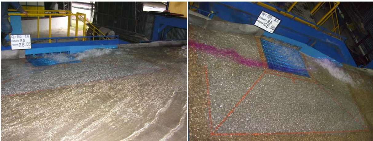
Figura 6.- Caso B: Izq. ( P_L=1\% ; P_T=3\% ; Q_T=180[\text{lt/s}] ) – Der. ( P_L=3\% ; P_T=2\% ; Q_T=180[\text{lt/s}] )
