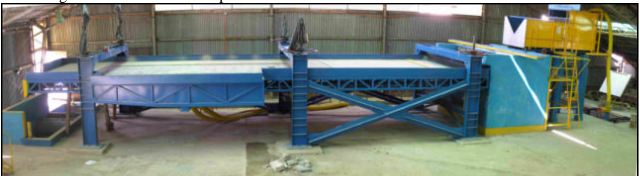
Figura 1.- Vista General del Banco Experimental de Sumideros de Aguas Lluvias
