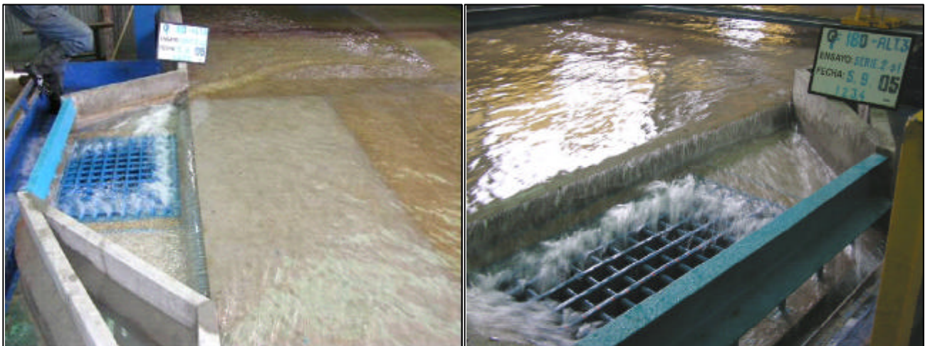
Figura 4.- Caso A: Izq. ( P_L=0.1\% ; P_T=3\% ; Q_T=80 [lt/s]) – Der. ( P_L=0.1\% ; P_T=1\% ; Q_T=180 [lt/s])
