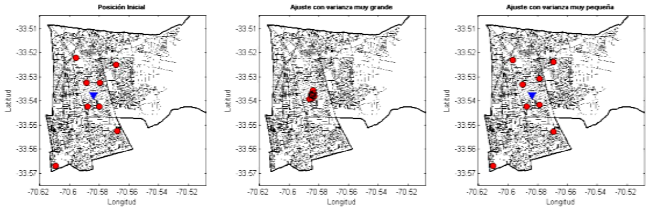
Figura 42: Comparación entre el ajuste producido por diferentes varianzas. En la imagen de la izquierda se aprecian las posiciones iniciales de las partículas; en la imagen central se aprecia el efecto de una matriz de covarianza de valores muy altos, produciendo un acercamiento de todas las partículas independiente de su lejanía a la observación; en la imagen de la derecha se aprecian los efectos de una matriz de covarianza con valores muy pequeños, sin notarse un claro desplazamiento incluso de las partículas cercanas.
