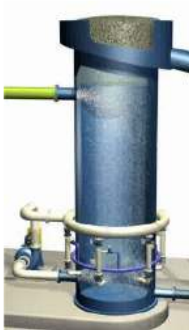
Fig. 11 Columna de geometría cilíndrica sin divisores internos y con sistema de inyección de aire externo.
