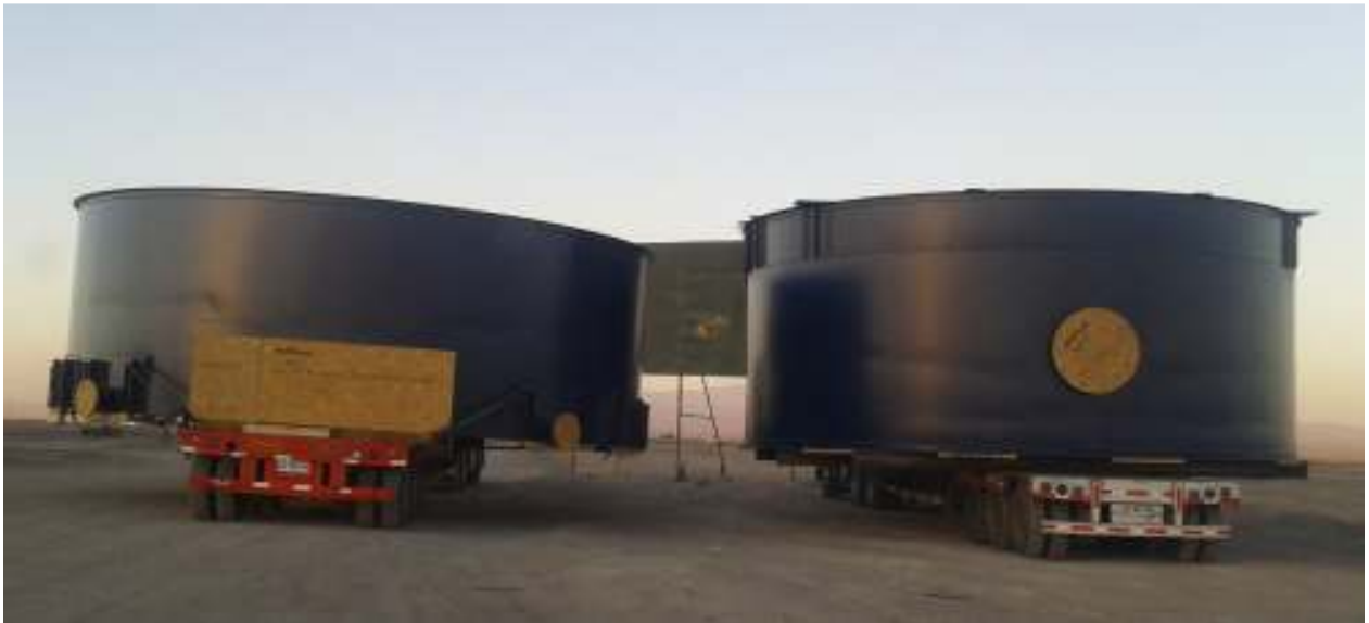
Fig. 25. Transporte de tanques de celdas de flotación. Carga sobredimensionada para transporte por carreteras.
