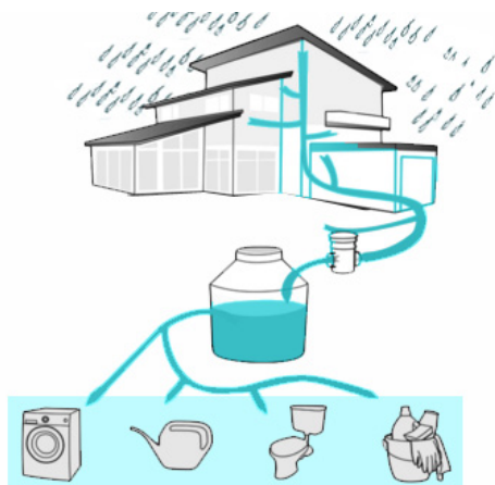
Fig. 65 | Sistema de recolección de aguas lluvias para reutilización en aguas grises Fuente: Elaboración propia
