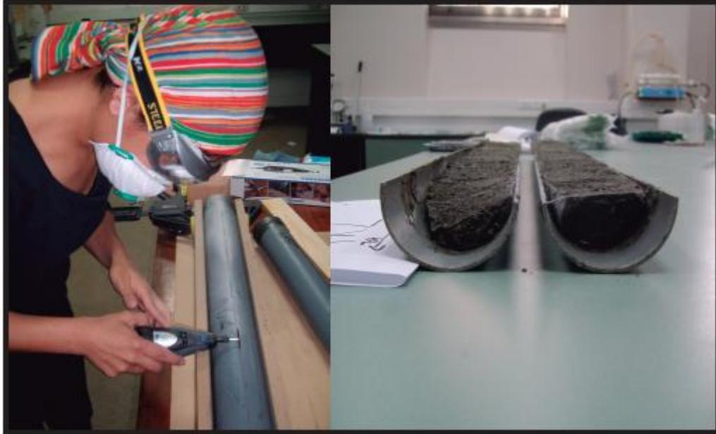
Figura 2.10. Maniobra de división del testigo TK2 para posterior submuestreo.
