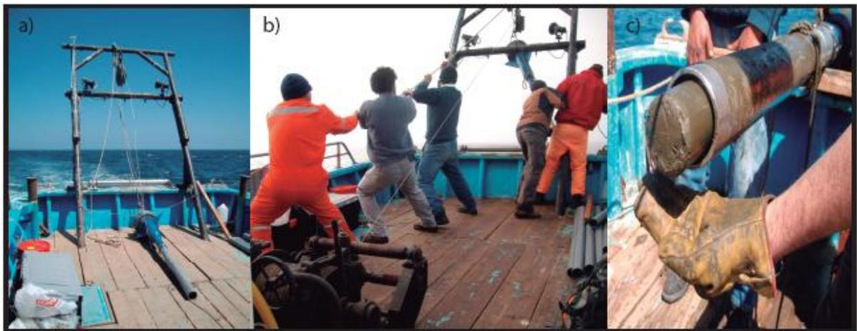
Figura 2.7. Extracción de testigo marino. a) Testigo de gravedad; b) Maniobra de extracción en embarcación Stella Maris R/V; c) Testigo marino extraído
