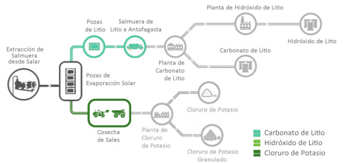
(Img.9) Esquema de Procesamiento del Litio de SQM (Base de datos de la empresa SQM) (Intervención Propia)
