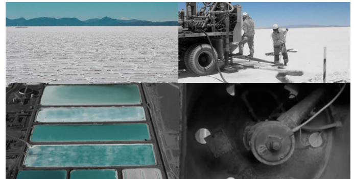
(Img.10) Fotografías del proceso de obtención de litio: estado natural, extracción, evaporación y purificación. (Fotografías de Google Img.) (Elaboración Propia)
