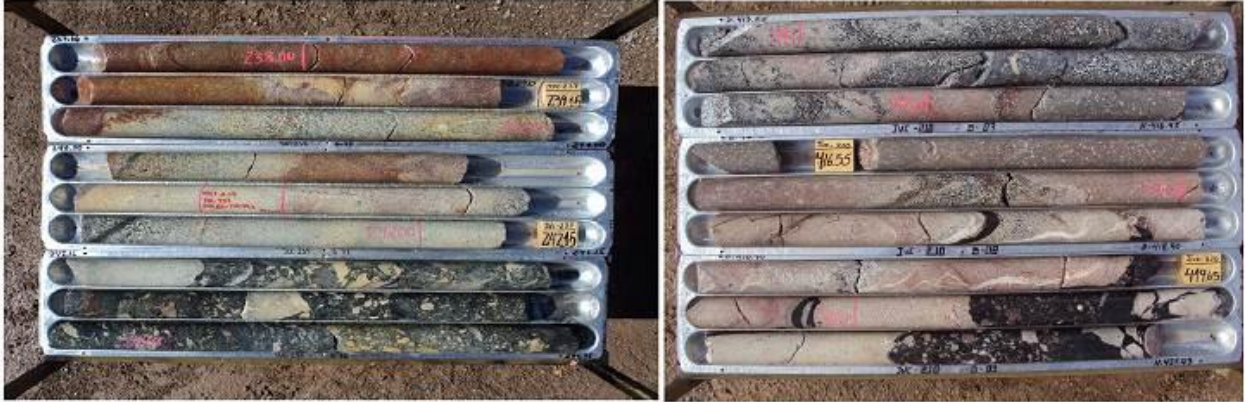
Foto 5.3.18: Sondaje JVC-237 y JVC-210 con UCS de 58.46 MPa y 59.36 MPa respectivamente.
