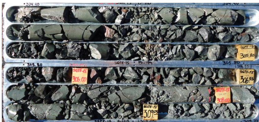
Foto 3.2: Segmento de sondaje con una alta frecuencia de Fracturamiento.
