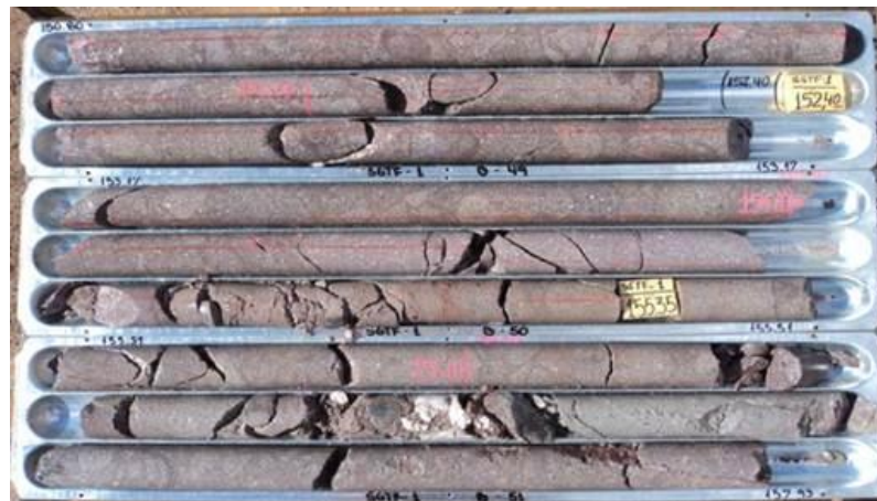
Foto 5.3.22: Sondaje SGTF-01 con UCS de 87.19 MPa.
