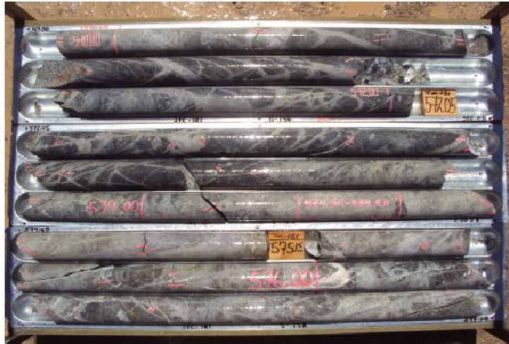
Foto 5.2: Sondaje JVC-181, desde 569.88 hasta 577.20 metros de profundidad, TUFAN con alteración clorita-sericita.
