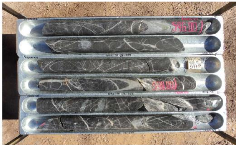
Foto 5.1: Sondaje GMC-10, desde 595.23 hasta 599.65 metros de profundidad, TUFAN con alteración potásica.
