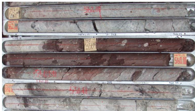
Foto 3.5: Zona afectada por cizallamiento (segmento de la Falla Roja).
