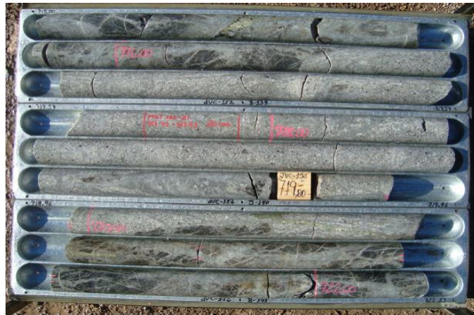
Foto 5.3.17: Sondaje JVC-152, metraje 717.73, UCS 161.75 MPa.
