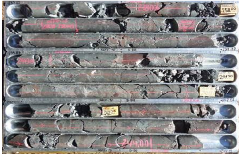
Foto 5.3.21: Sondaje SGTF-10 con UCS de 27.96 MPa.
