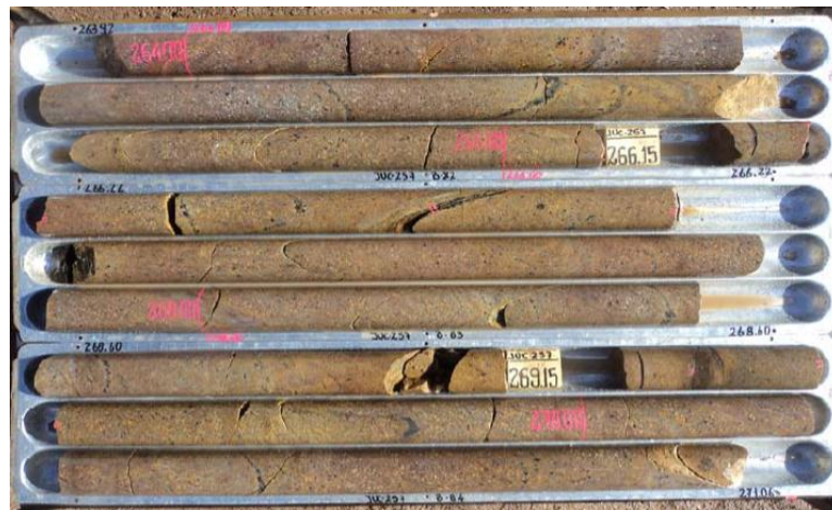
Foto 5.3.15: Sondaje JVC- 257 metraje 270.6, UCS de 17.84 MPa.
