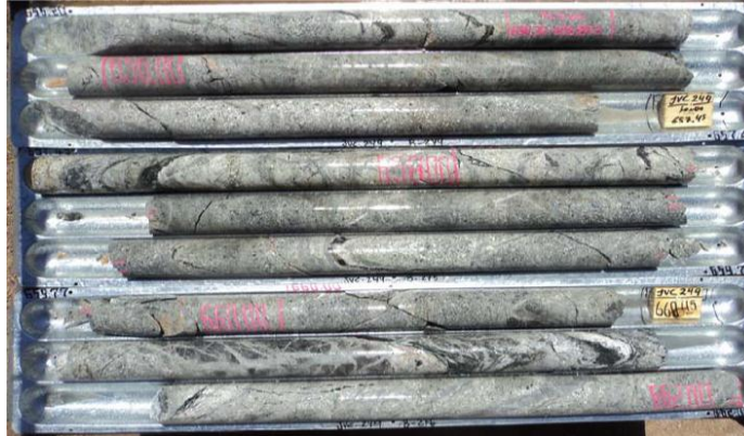
Foto 5.3.16: Sondaje JVC- 249 metraje 655.32, UCS de 32.71 MPa.
