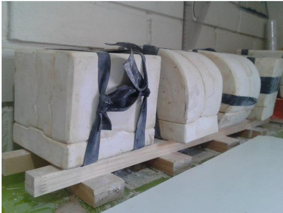
15. REPOSADO DE LOS MOLDES PARA DESHUMEDECER LA PIEZA ANTES DE DESMOLDAR
