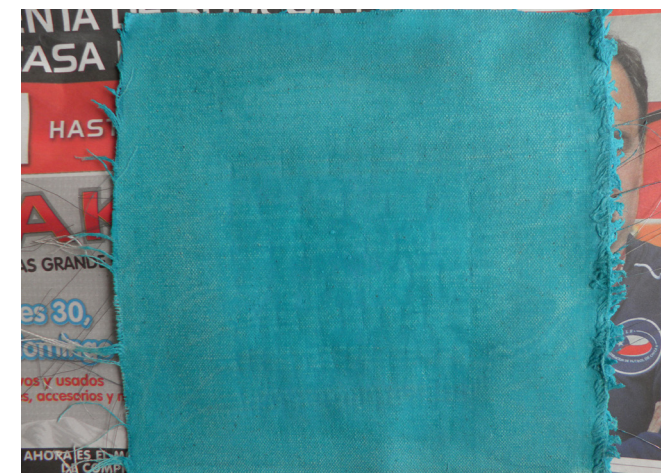
Lona con pintura termocrómica en proceso de secado.
