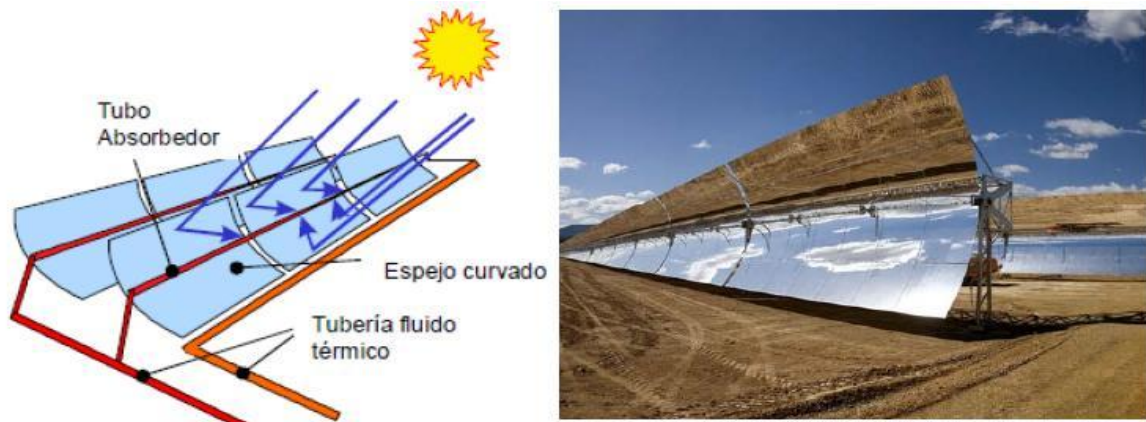
Figura 10. Colector Cilindro parabólico. (Sánchez, 2010)
