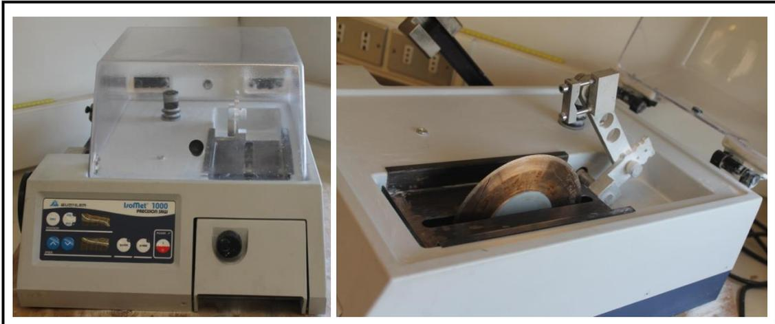
**En la figura 9 se observa la máquina recortadora a la izquierda, a la derecha se aprecia el disco diamantado para corte.**
