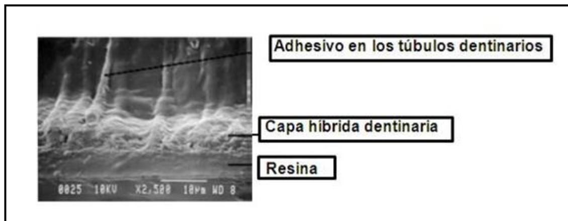
**En la figura se observa la formación de una capa híbrida con un grosor de 3-4 micrones después de la aplicación del Adhesivo 3M ESPE Adper Single**
