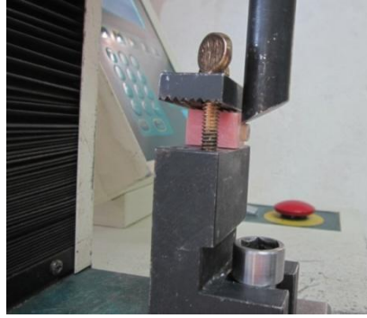
Figura 6: Fotografía máquina TINIUS OLSEN Modelo H5K-S durante el procedimiento de testeo.
