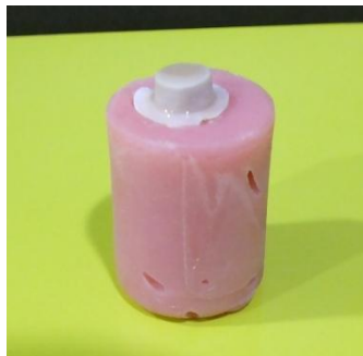
Figura 5: Disco de Alúmina posicionado sobre Esmalte dentina con RelyX U200.
