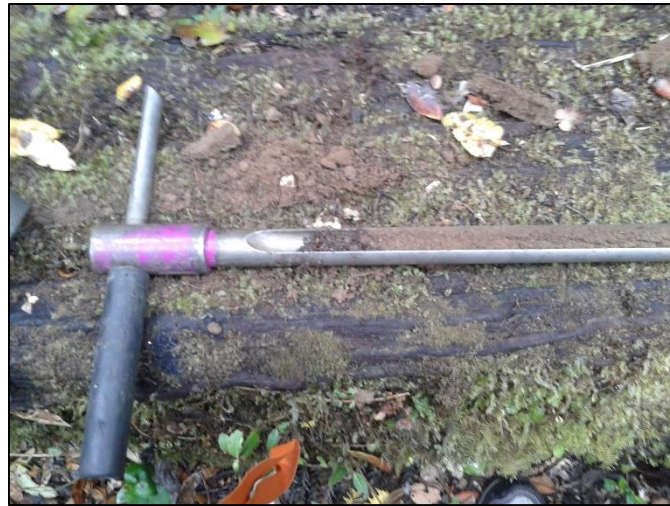
Figura 4.3: Bastón pedológico y muestra de suelo
