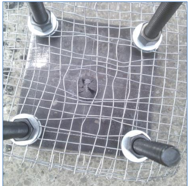
Figura 31 Ejemplo de falla de pellet ensayado con penetrómetro.
