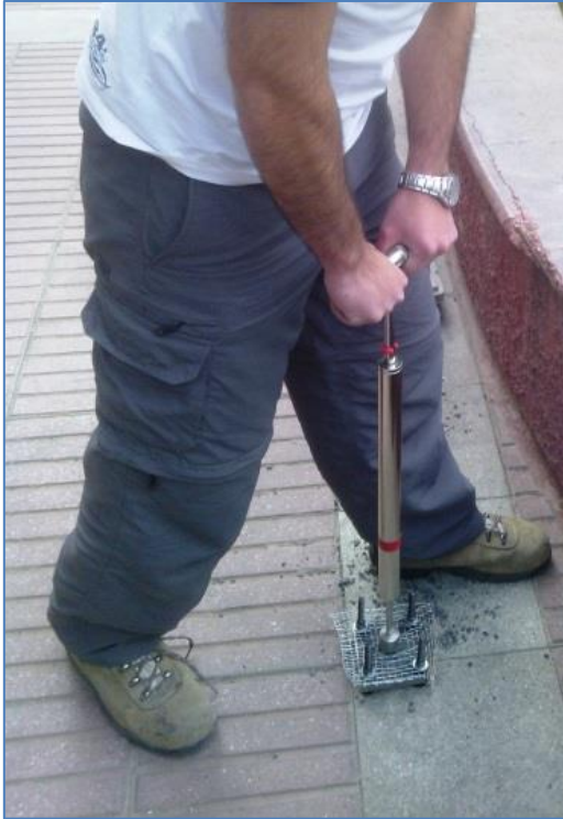
Figura 30 Ensayo con penetrómetro.
