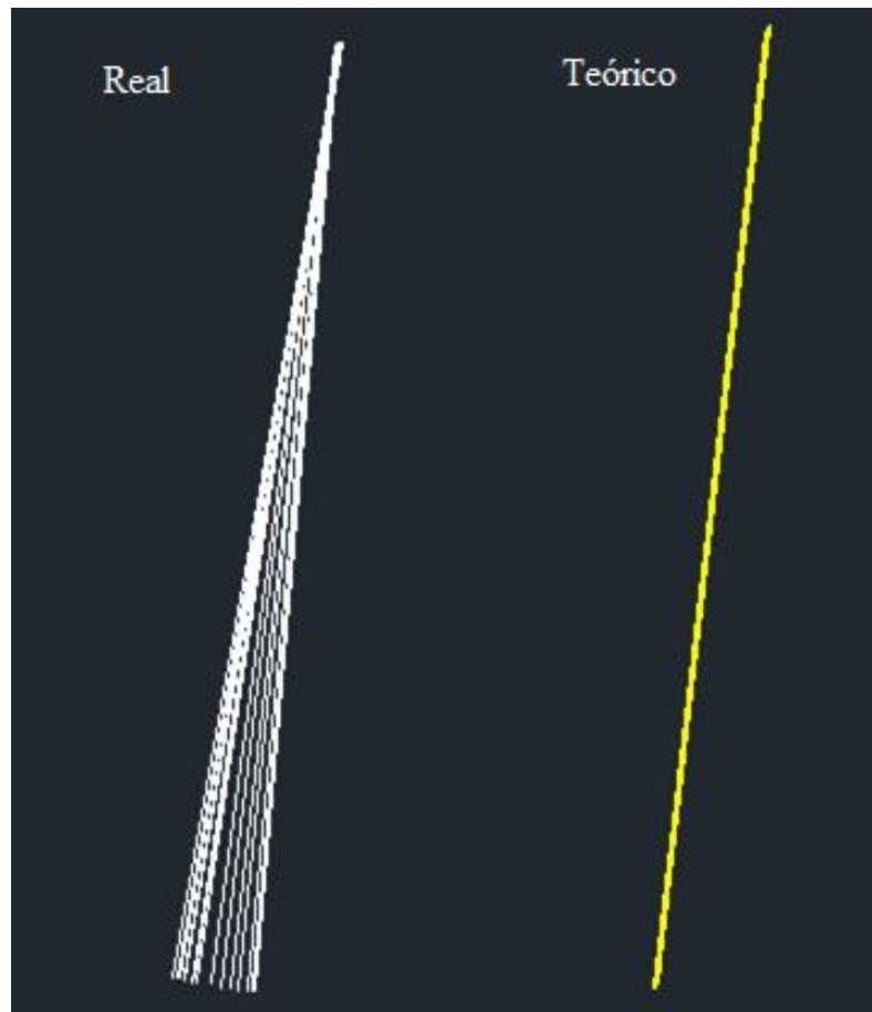
Ilustración 54: Vista lateral tiros de precorte.
