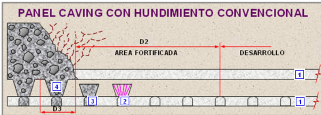
Figura 5: Secuencia operacional general del hundimiento convencional (Salgado, 2009).
