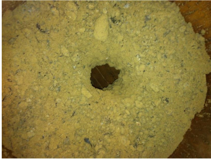
Figura 76: Colgadura alta, experimento 20% finos y 15% humedad, vista superior
