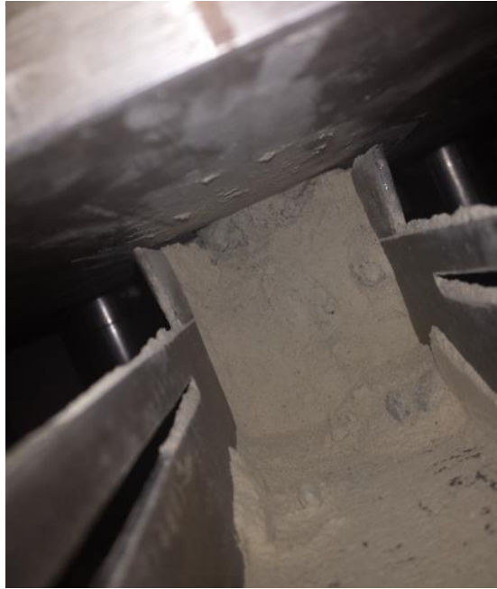
Figura 78: Colgadura en punto de extracción, experimento 40% finos
