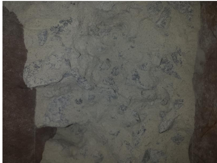
Figura 77: Colgadura alta, experimento 40% finos, vista inferior
