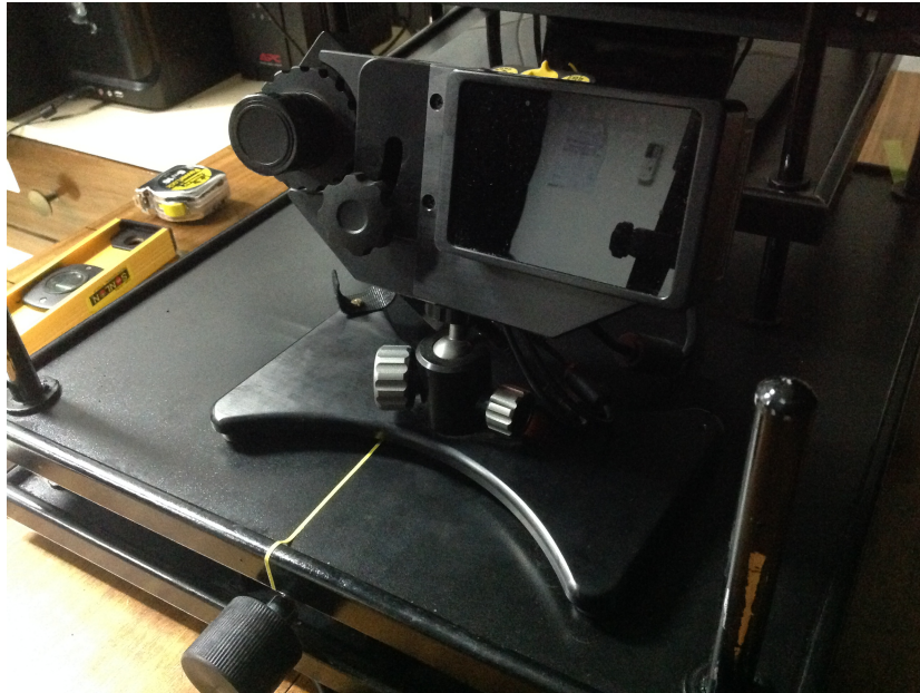
Figura 4.1: Cámara infrarroja del Eye Tracker. Fuente: Archivo personal.
