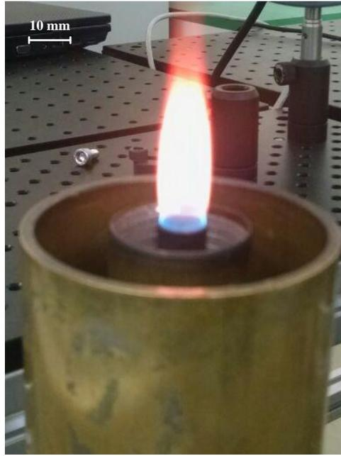
Figura 4.2: Imagen de una llama inversa típica generada en el laboratorio.
