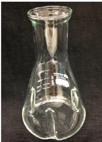
Figura 16: Matraz Erlenmeyer de 250 ml con 3 deflectores utilizado para los cultivos de células en suspensión de A. chilensis .
