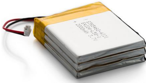
Figura 2-2: Módulo Ión-Litio conformado por 3 celdas, Fuente: www.electan.com
