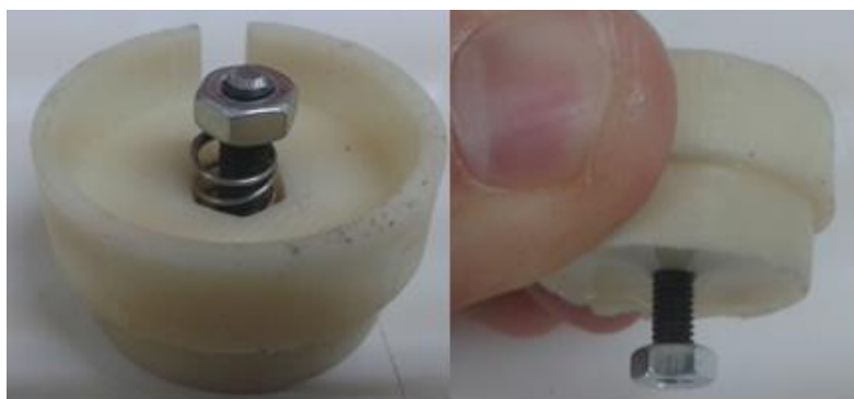
Figura 7-16: Posicionando Prisionero e instalando la Tuerca
