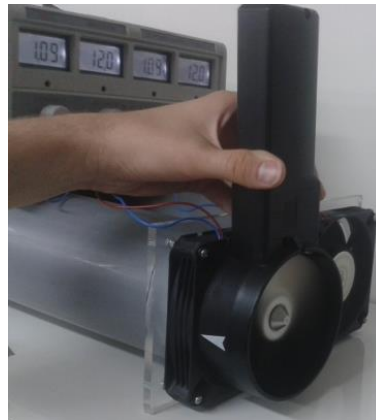
Figura 3-41: Medición de velocidad de entrada utilizando flujometro
