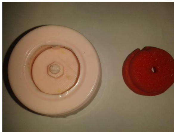
Figura 7-5: Molde de silicona y su respectivo master
