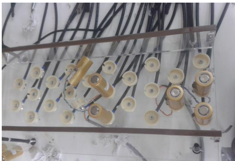
Figura 7-9: Pegado de Termocuplas a Celdas
