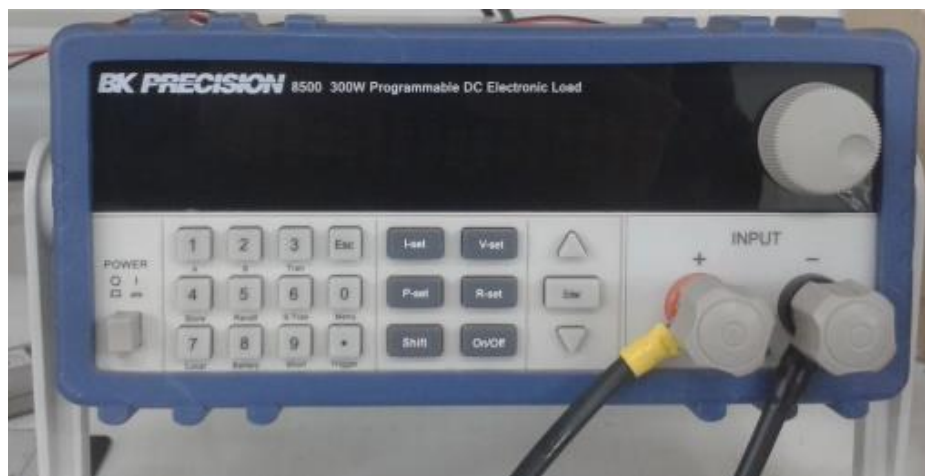
Figura 3-7: Carga programable BK Precision 8500
