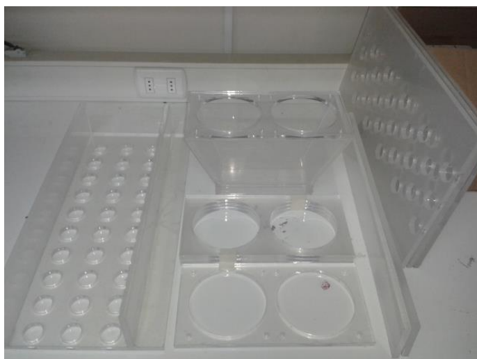
Figura 7-2: Piezas Maquinadas y Pegadas
