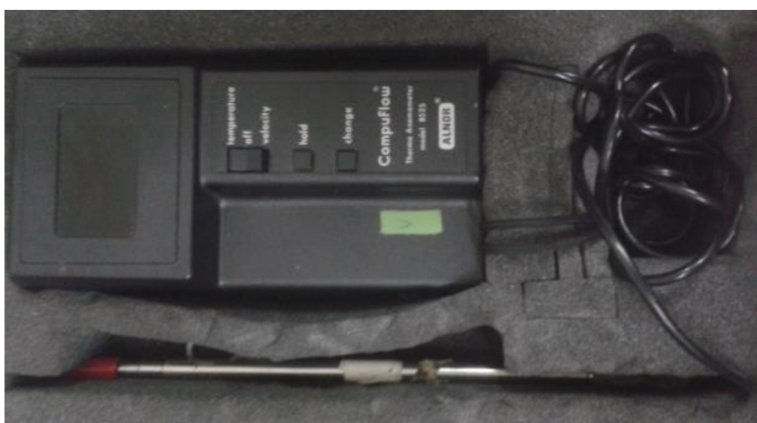
Figura 3-29: Termo Anemómetro ALNOR 8525
