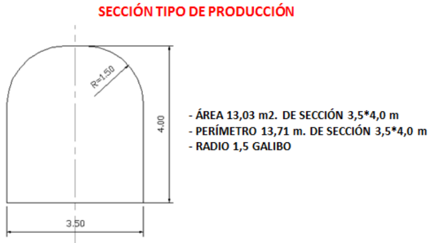
Figura 4-15: Sección tipo galería de producción
