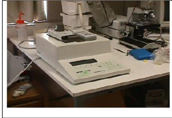
Figura 14: Equipo DTA el cual utiliza una mesa Mettler Toledo FP84HT que es controlada mediante un procesador FP 90, el que está conectado a un PC para el almacenamiento de los datos
