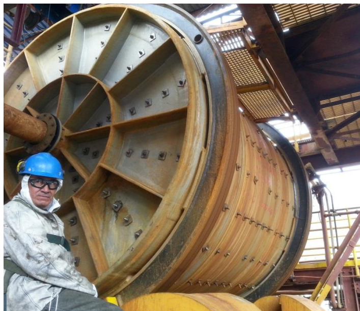
Figura 2-15. Tambor rotatorio utilizado en el proceso de Cementación.
