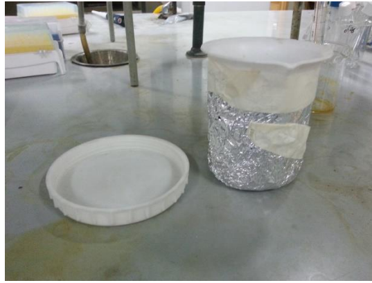
Figura 3-6. Contenedor de plástico utilizado como recipiente para realizar los experimentos de cementación.
