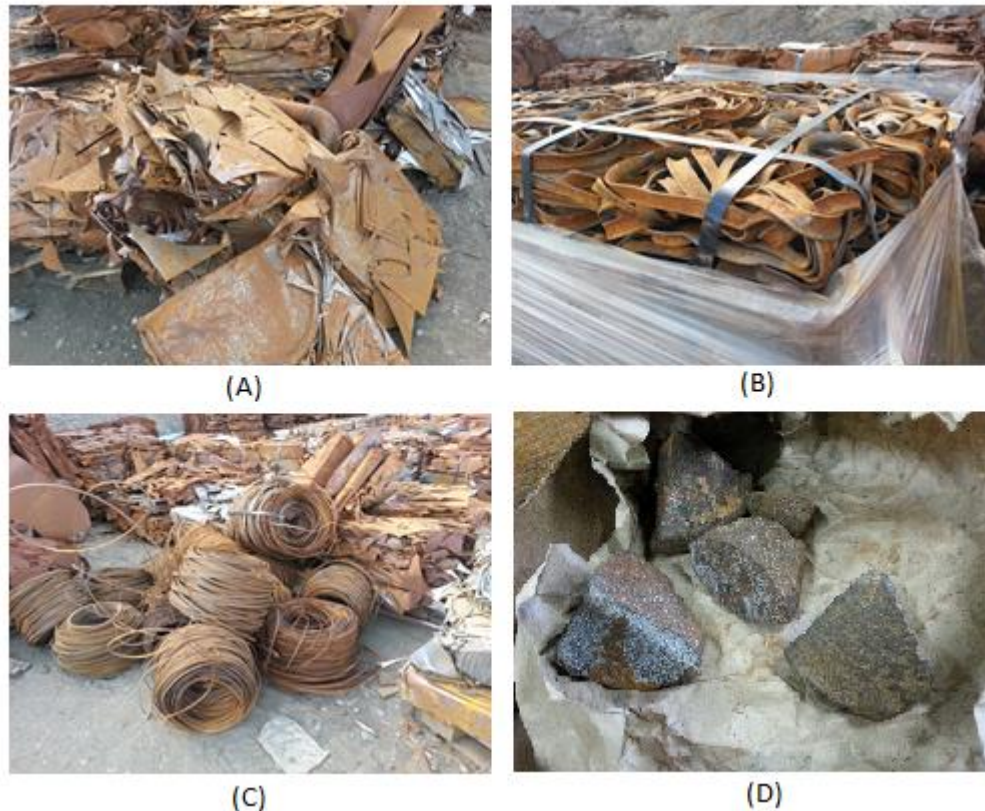
Figura 3-4. Materiales evaluados en este estudio. (A) Láminas de hierro. (B) Tiras delgadas de hierro. (C) Alambres rígidos de hierro. (D) Chips de bolas de acero.
