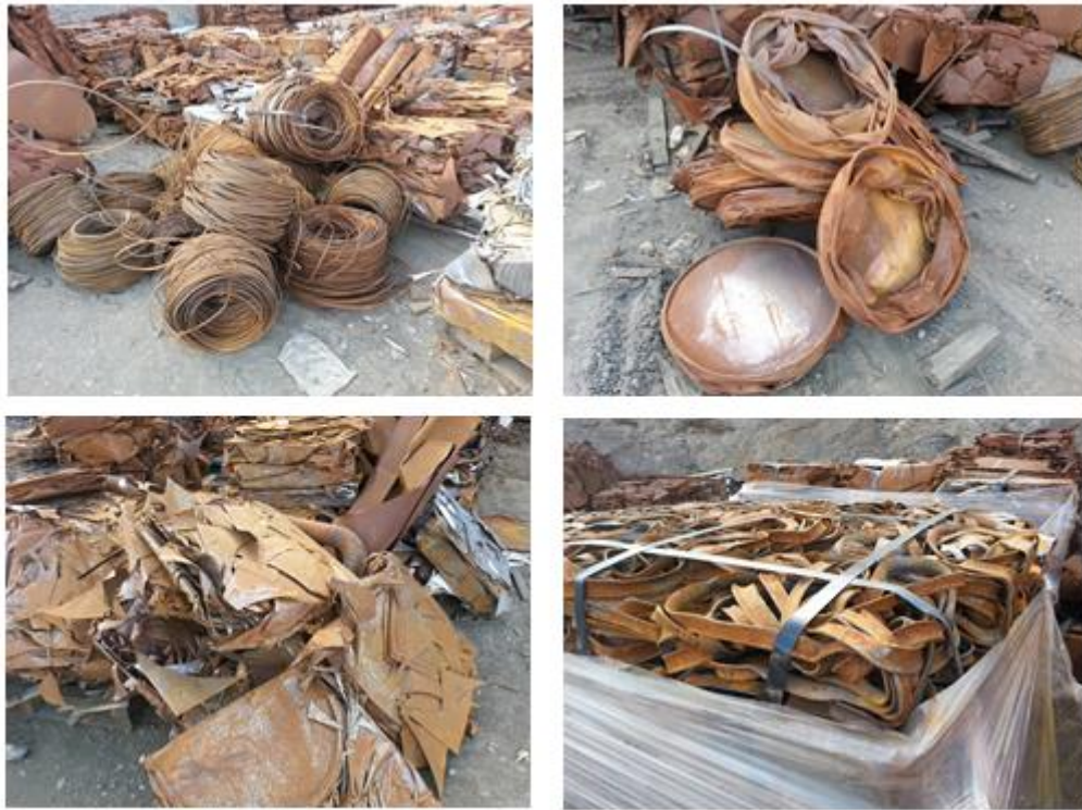
Figura 2-14. Chatarra de hierro utilizada en el proceso de Cementación.
