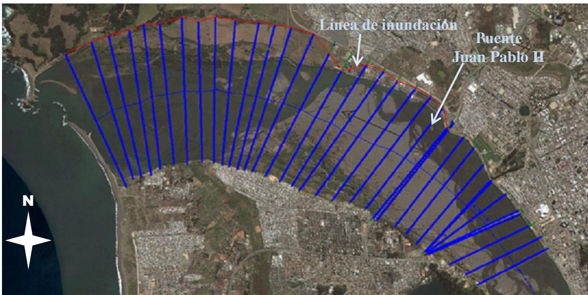
Figura 5.20: Planta que muestra el alcance de la inundación, en la ribera norte aguas abajo del puente Juan Pablo II, durante la crecida de julio de 2006, según el modelo HEC-RAS en régimen no permanente.
