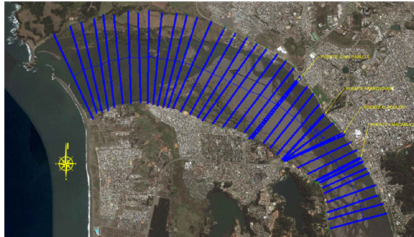
MODELO HEC-RAS DE FLUJO PERMANENTE PLANTA EJE HIDRAÚLICO DEL RÍO BÍOBIO PARA LA CRECIDA DE T=150 AÑOS SIN ESCALA
