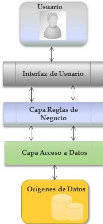
Figura 13. Diagrama de Arquitectura tres capas del Sistema de Gestión de Cambio de Aplicaciones
