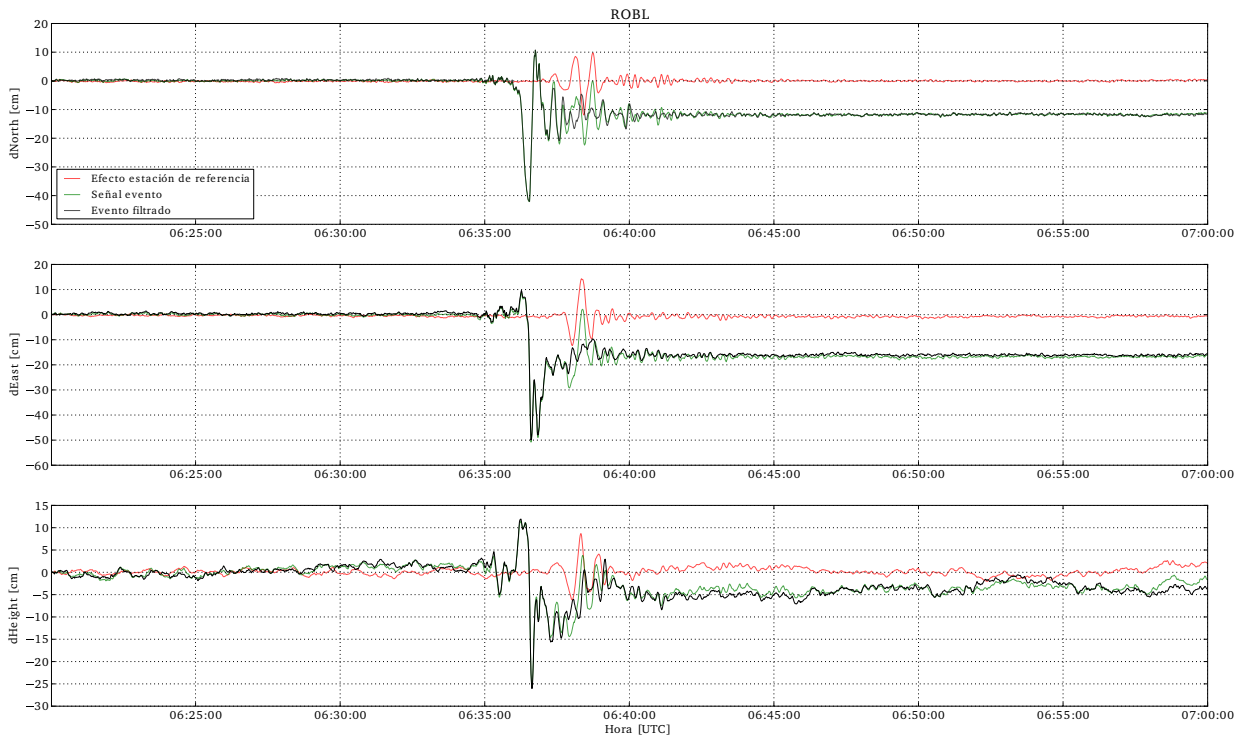
Figura 3.7: Filtro espacial (rojo) construido para remover la señal común producida por la estación de referencia a la señal del terremoto de Maule (verde). La línea negra corresponde al resultado de la aplicación del filtro.
