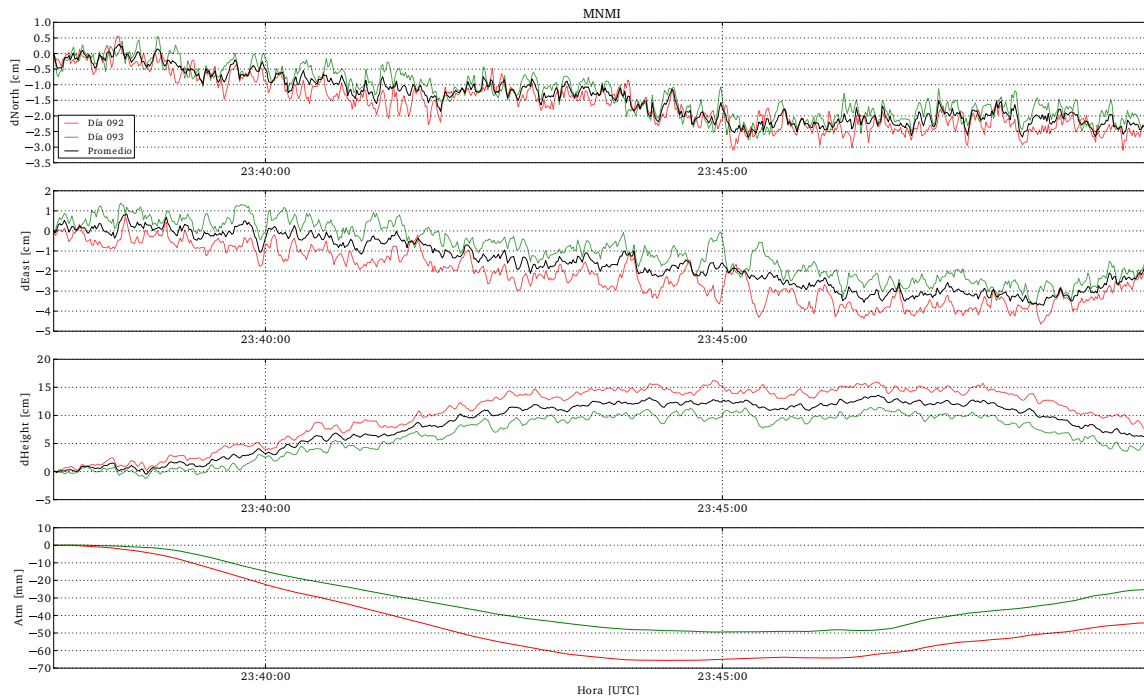
Figura 3.9: Filtro sidereal de la estación MNMI para el terremoto de Iquique, 2014. La línea negra corresponde al promedio ponderado de los dos días de observación utilizados para su construcción.
