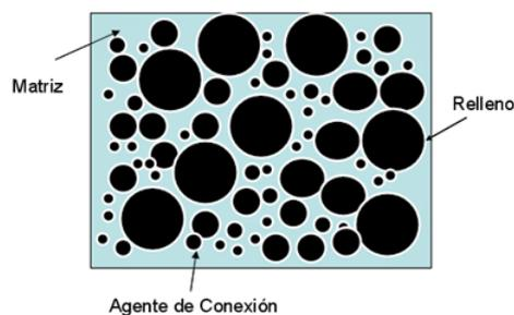
Fig 1: estructura básica de los composites
