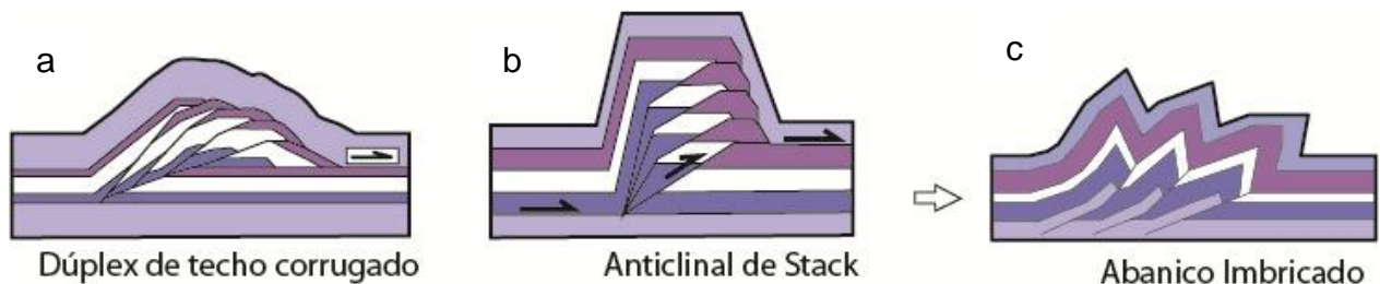
Figura 28: Tipos de pliegues formados en ambientes compresivos: (a) Dúplex de techo corrugado (b) anticlinal de stack y (c) abanico imbricado (McClay, 1992).
