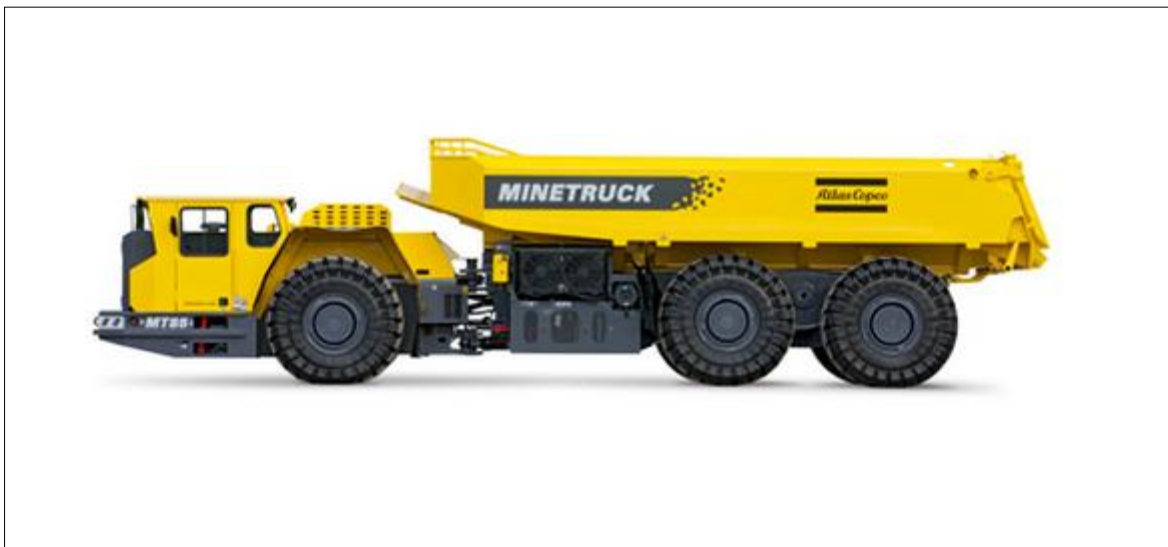
Figura 12: Camión minero subterráneo
