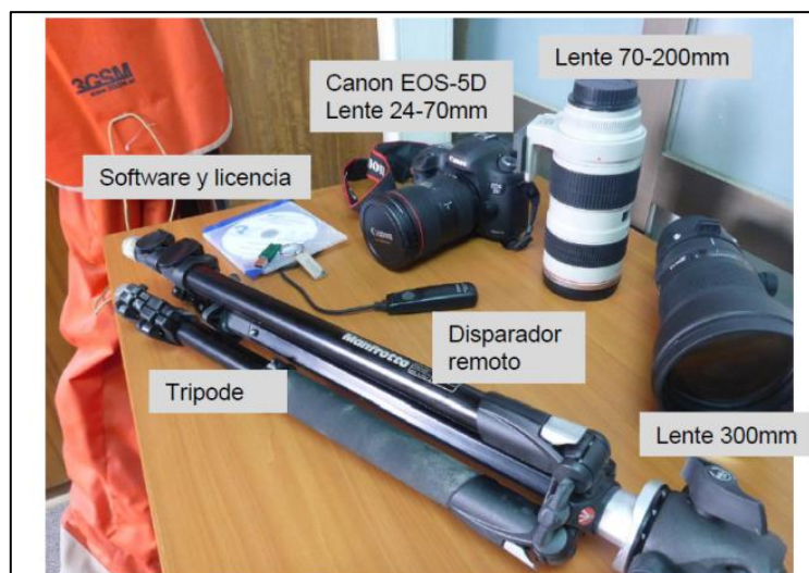
Figura 8: Equipo utilizado en la campaña de mapeo: Se observa el software SMB, la licencia de este, la cámara calibrada y tres lentes de aumento (Canon EOS-5D Mark III y lentes de 24-70mm, 70-200mm y 300mm).
