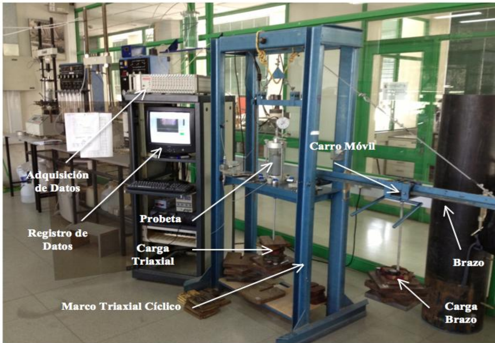
Figura 3.3. Componentes del equipo triaxial cíclico de bajas presiones.
