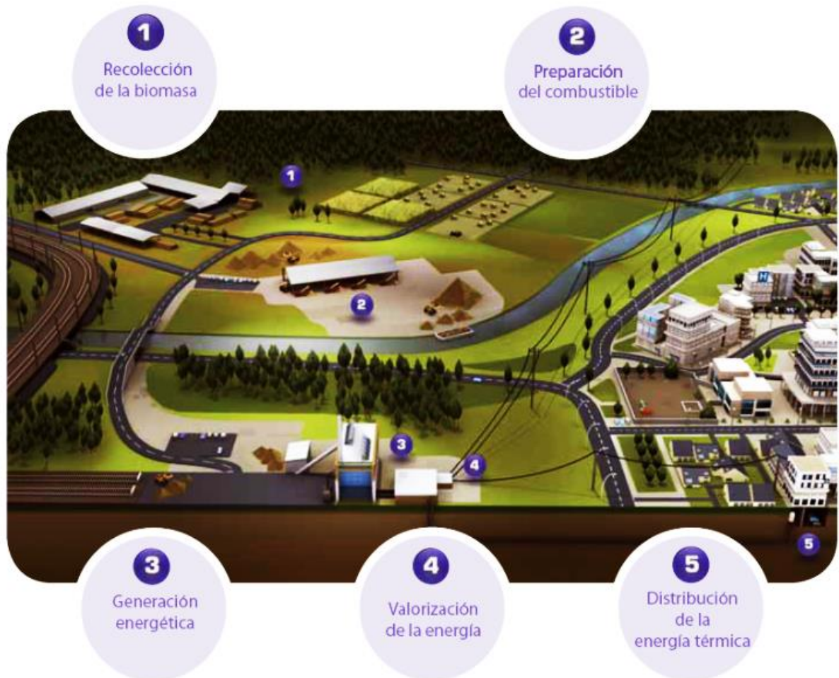
Figura 12: Etapas de la Generación de Energía Eléctrica
