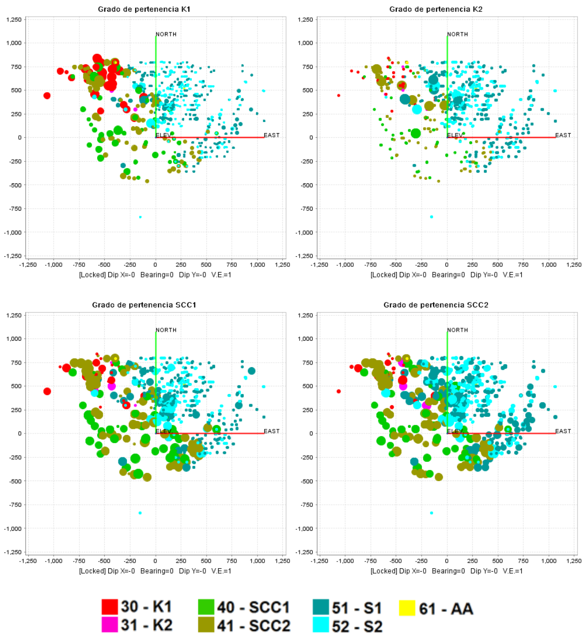
Figura 7.6. Planta Cota 2750 ± 50 m. Tamaño de las muestras representa el grado de pertenencia a un cluster.
