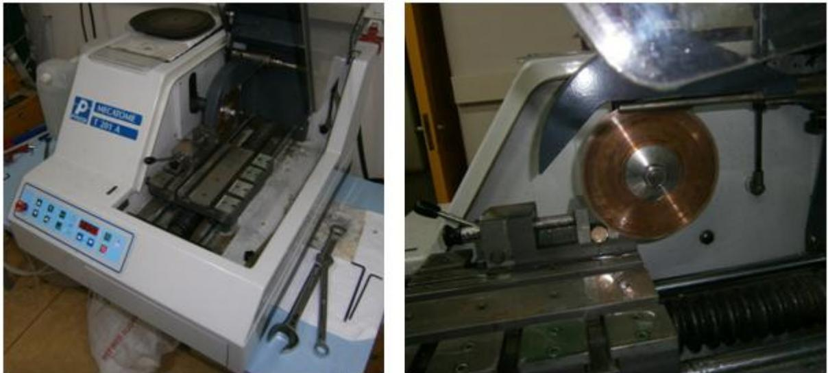
FIGURA 3-8: MÁQUINA DE CORTE POR DISCO.
