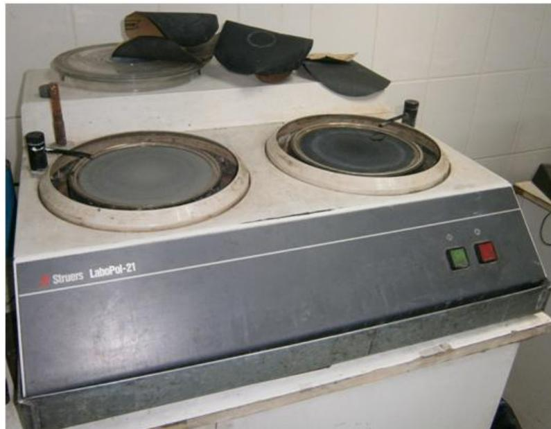
FIGURA 3-4: MÁQUINA PARA PULIR CON DISCOS DE LIJA AL AGUA.
