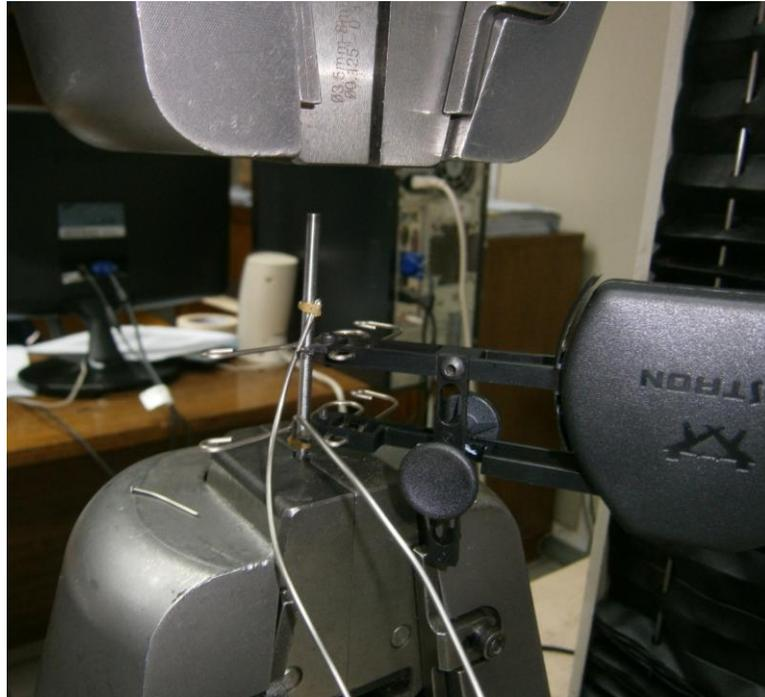
FIGURA 3-18: POSICIONAMIENTO DE LA PROBETA CON LAS TERMOCUPLAS Y EL EXTENSÓMETRO CORRESPONDIENTE EN LA MÁQUINA DE TRACCIÓN INSTRON DEL IDIC.
