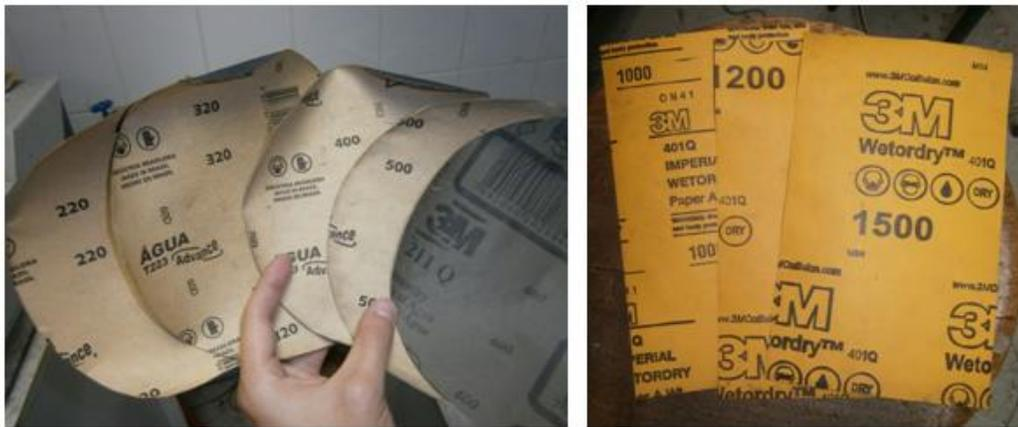
FIGURA 3-3: LIJAS UTILIZADAS EN EL PROCESO DE PULIDO.
