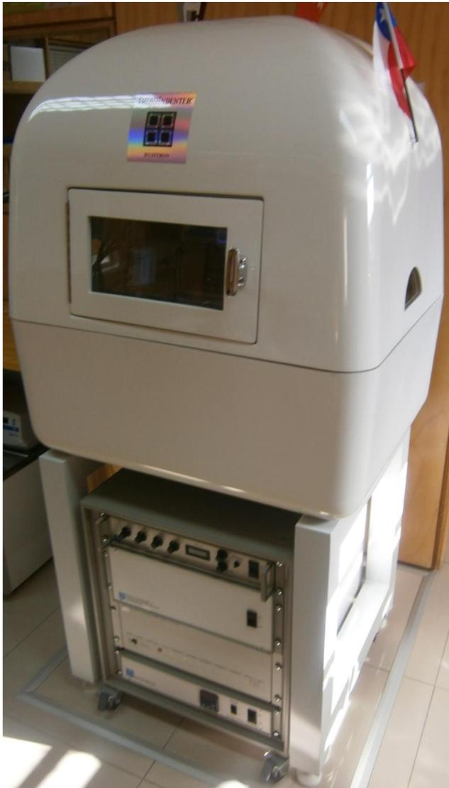
FIGURA 3-25: NANOINDENTADOR TRIBOSCOPE HYSITRON NANOMECHANICAL TEST INSTRUMENT.
