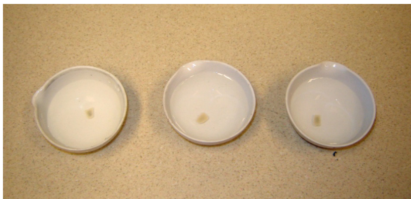
Fig. N° 6: Lavado de las muestras en agua destilada
