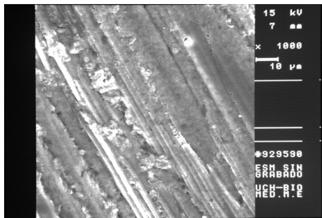
Fig. N°16: Fotografía MEB de muestra de adhesivo sin grabado ácido 1000X
