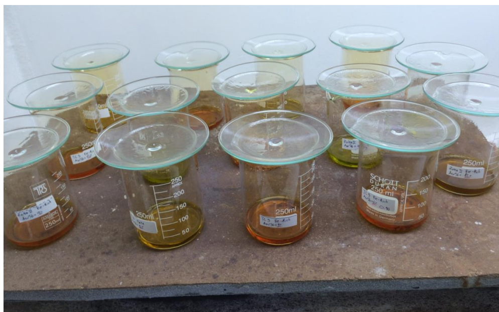
Figura 31 Digestión acida de muestras para análisis ICP-OES
