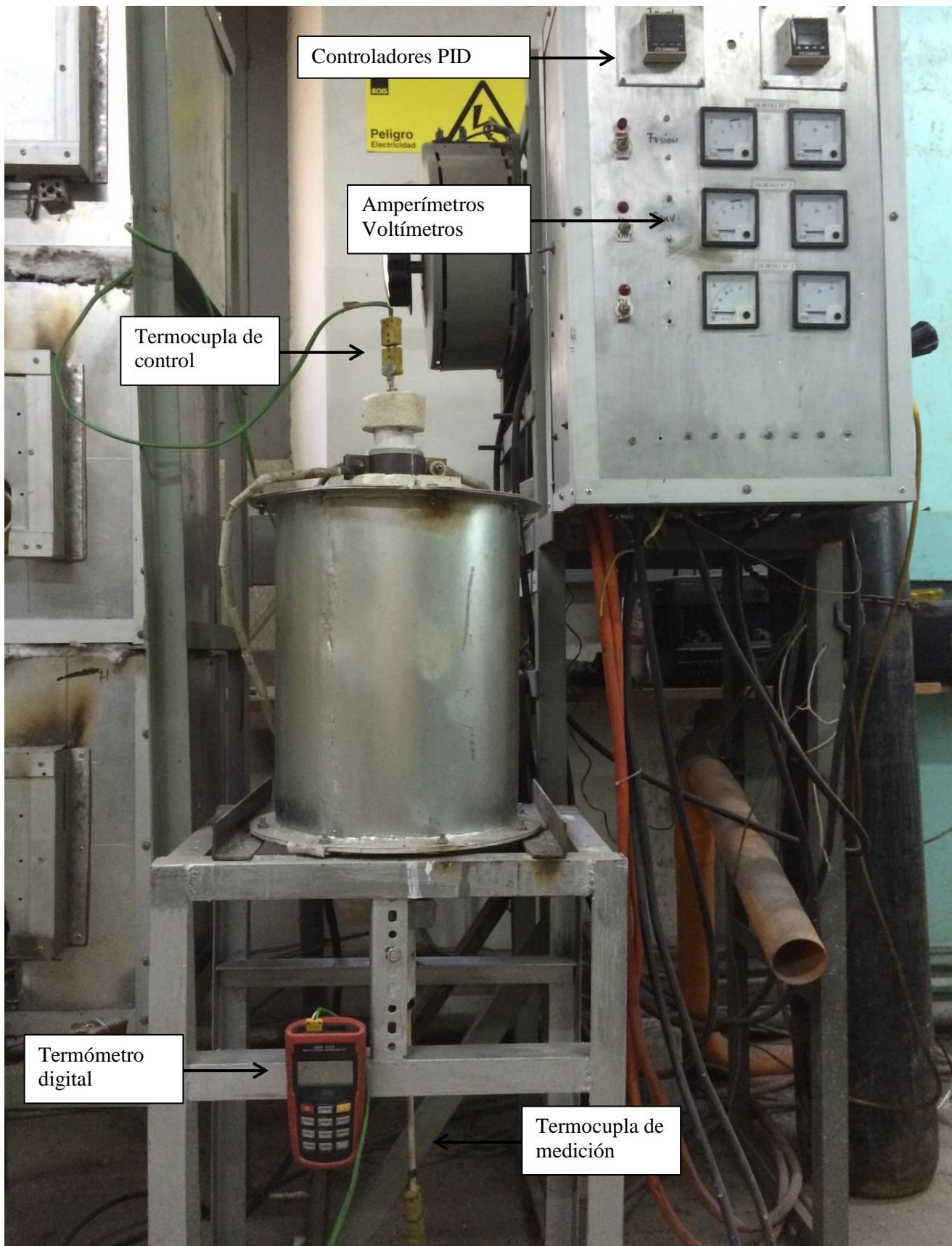
Figura 25 Instalación completa de aparato experimental para prueba a escala de laboratorio
