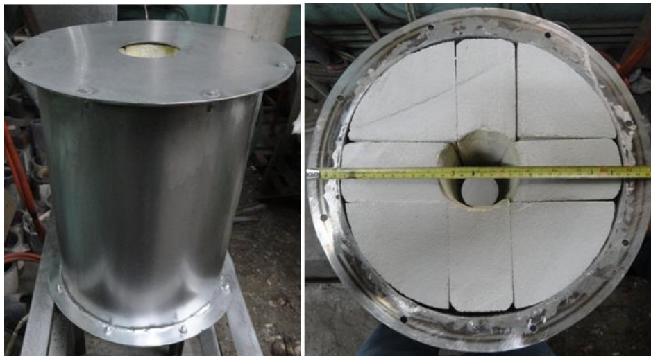
Figura 24 Carcasa acero inoxidable y relleno de ladrillos.
