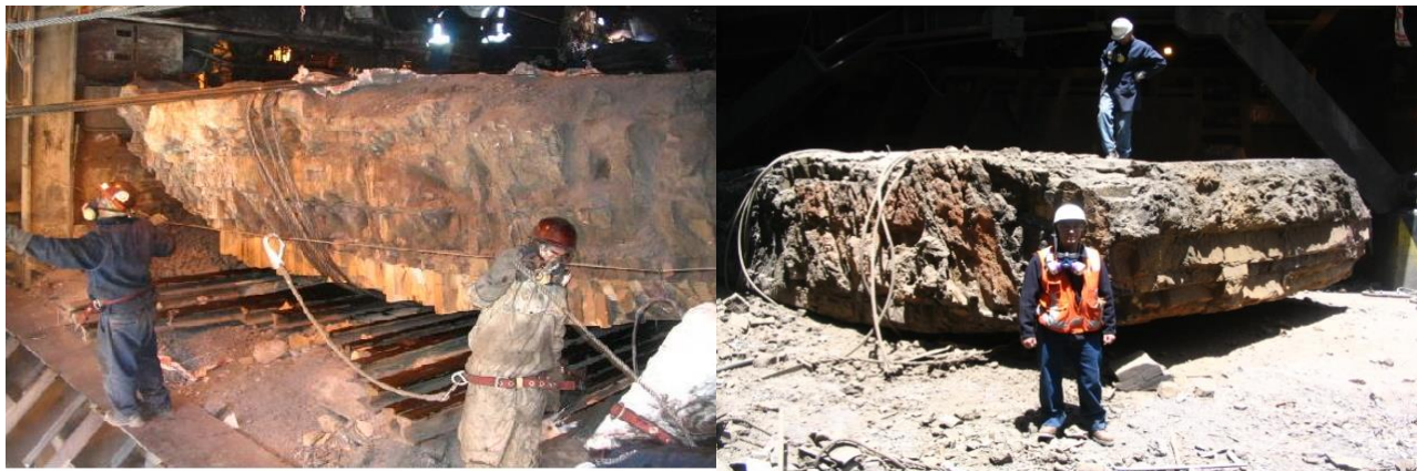
Figura 3 Evento de formación de speiss en el fondo del Horno Flash
