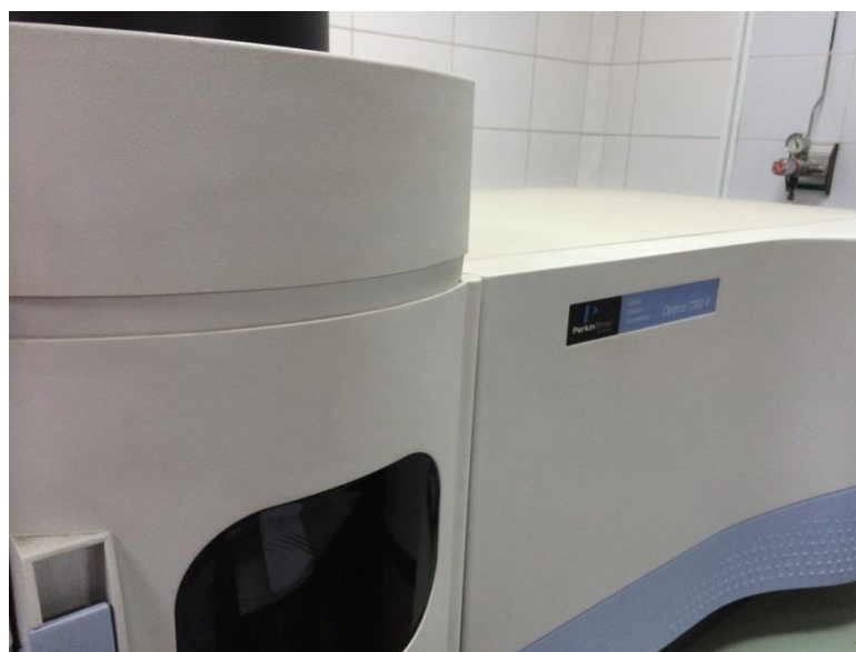
Figura 30 Equipo de análisis ICP-OES modelo OPTIMA 7300 V Perkin Elmer
